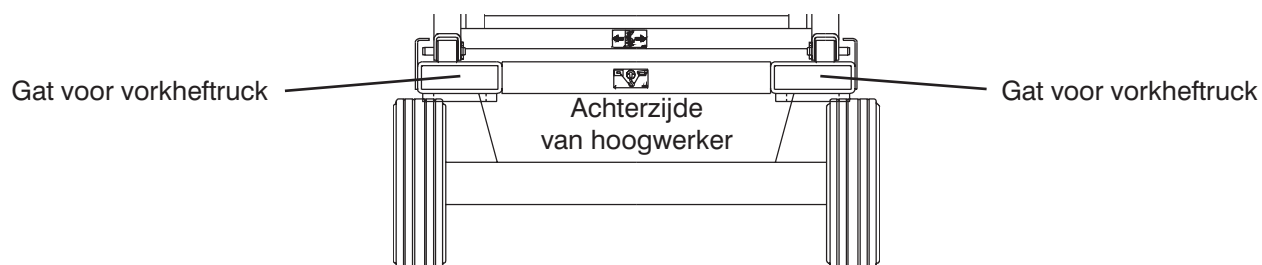
Figuur 2-19. Gaten voor vorkheftruck
