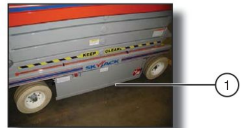
Figuur 2-7. Bescherming tegen kuilen
