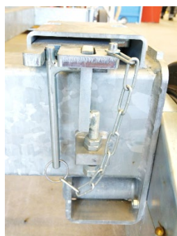
Rijden met aandrijving (tandwiel in ingrijping)
